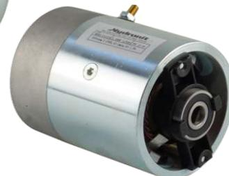
**Motori DC cassa 151:** Sono motori per impieghi particolarmente gravosi, con ventola di raffreddamento, protezione termica e tempo di funzionamento fino a 16min o più. Disponibili con potenze a partire da 2,5kW 12VDC fino a 4kW 24VDC.
