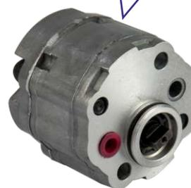
**Serie R.** pompe reversibili, con valvole di ritegno in aspirazione integrate e porte di uscita sulla flangia anteriore. Possono essere fissate con una flangia di adattamento sul corpo centrale tipo UR.
