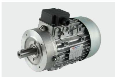
**Motori B14 IEC:** per compatibilità con gli standard di mercato, possono essere montati anche motori B14 con cassa 71, 80, 90, 100 e 112. In questo caso devono essere utilizzati due semigiunti e una flangia di adattamento come indicato nelle tabelle A170, A180, A190, A200.
